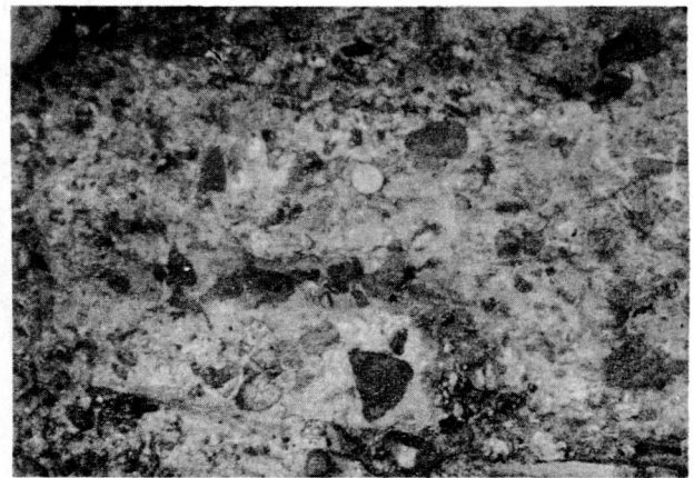
Fotografía 7. Sección delgada de vulcanita platinífera. Puede observarse un fenocristal de cuarzo con bahía en una mesóstasis microcristalina.
