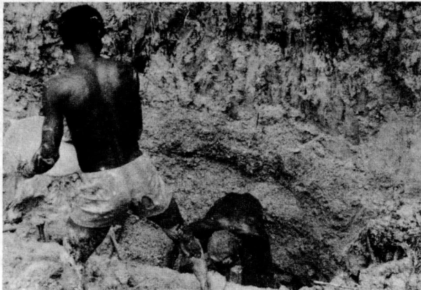
Fotografía 3. Extracción de platino en rocas piroclásticas ácidas meteorizadas.
