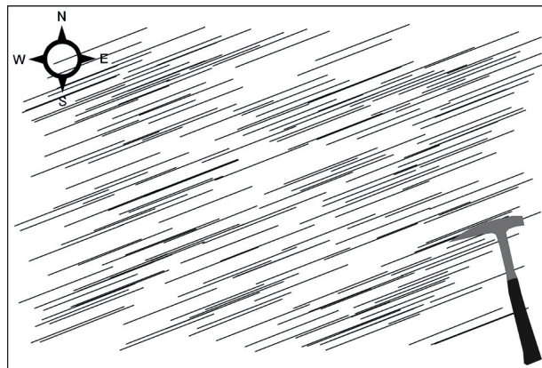
Fig. 11. Patrón de afloramiento de la familia de fractura de dirección N60E.
