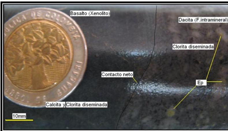
Fig. 7. Contacto Dacita postmineral con basaltos del Complejo Barroso-Amaime (?). Ejemplo de alteración propilítica en basaltos, y en rocas porfíricas (Dacita).
