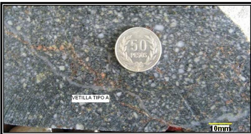
Fig. 15. Vetilla tipo A. Nótese la forma sinuosa y la ausencia de halo de alteración (Reacción).
