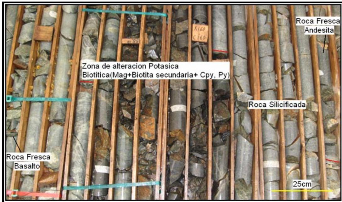
Fig. 10. Contacto Andesita (primera fase) con basalto. Nótese la zona de roca silicificada, antecedendo la zona de alteración potásica- biotítica (Roca oscura).
