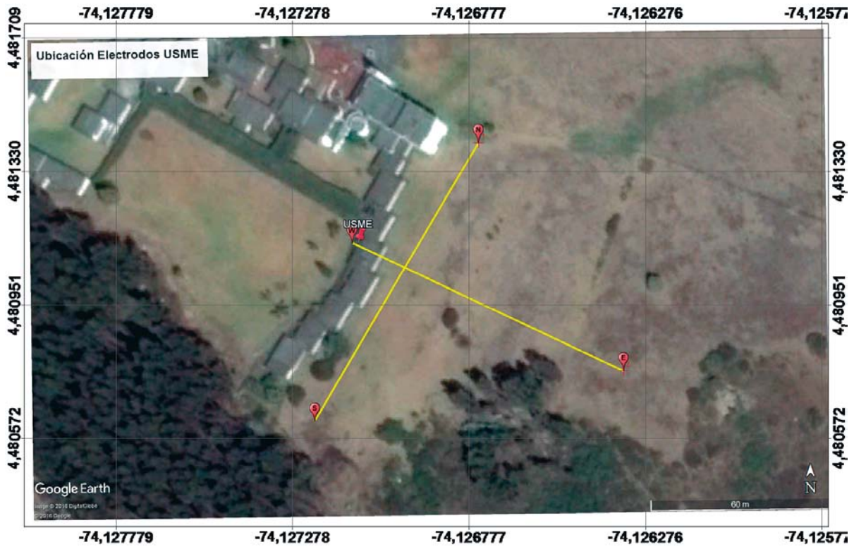
Figura 6. Ubicación electrodos estación Usme (USME). Dipolo N-S = 97 m; dipolo E-W = 98 m. Usme (USME) station electrodes location. N-S dipole = 97m; E-W dipole = 98m
