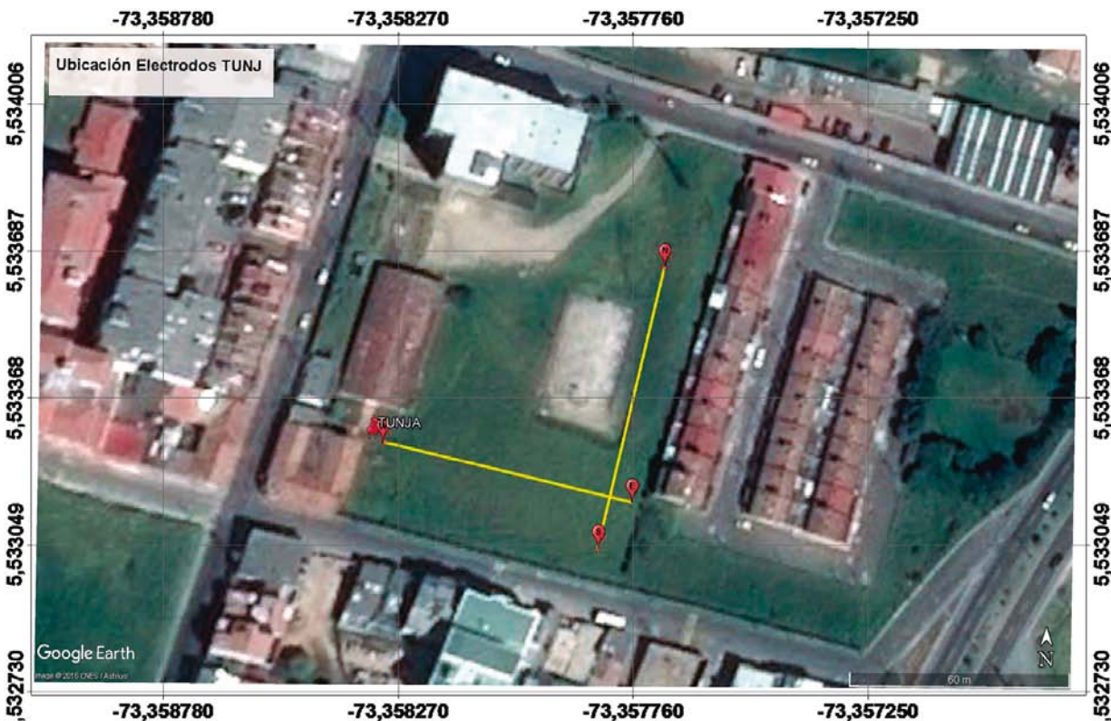
Figura 5. Ubicación electrodos estación Tunja (TUNJ). Dipolo N-S = 85 m; dipolo E-W = 67 m.
