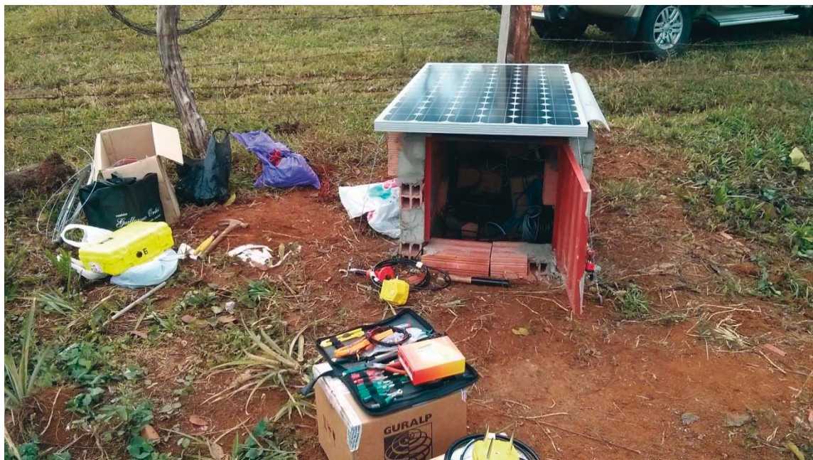
Figura 2. Caseta típica para el sistema de adquisición de la red portátil (estación sísmológica CH-06).
