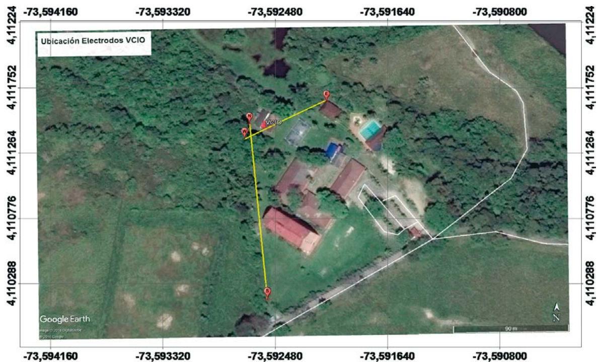
Figura 7. Ubicación electrodos estación Villavicencio (VCIO). Dipolo N-S = 130 m; dipolo E-W = 70 m. Villavicencio (VCIO) station electrodes location. N-S dipole = 130m; E-W dipole = 70m
