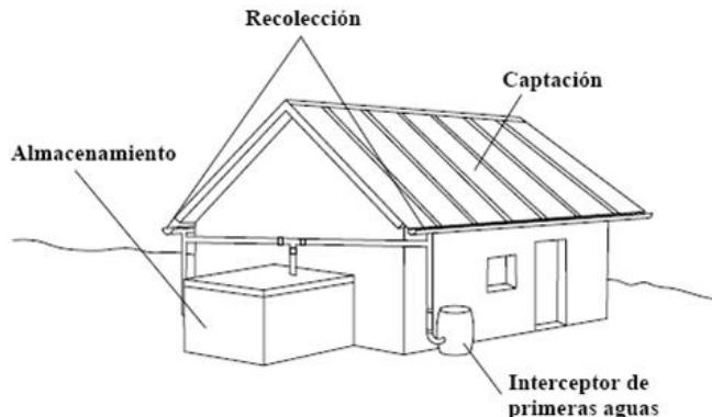
**Figura 1.** Sistema típico de captación de agua lluvia en techos.
