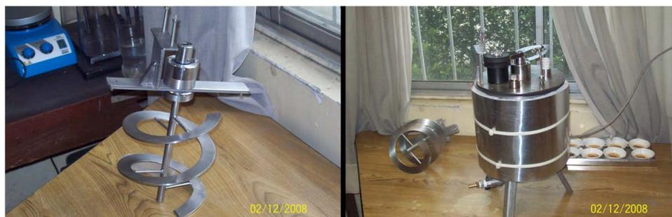
**Figura 2.** Biorreactor de tierra activada con agitador de cinta helicoidal.
