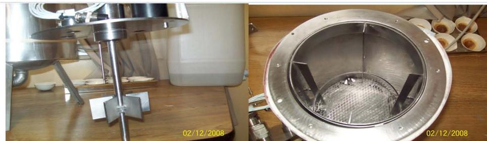
**Figura 1.** Reactor de tanque agitado.
