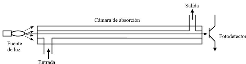
**Figura 4.** Fotómetro con cámara de absorción (esta gráfica no se tomó de ninguna fuente, fue realizada por los autores)
