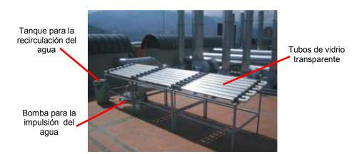
Figura 2. Colector usado para la fotólisis solar
