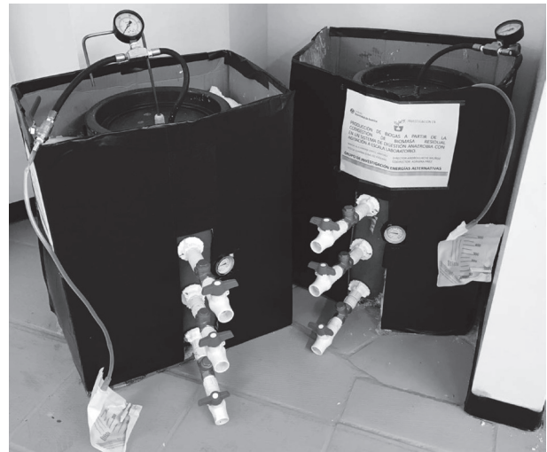
Figura 3. Montaje de los sistemas de digestión. A la izquierda BD2A y derecha BD1
