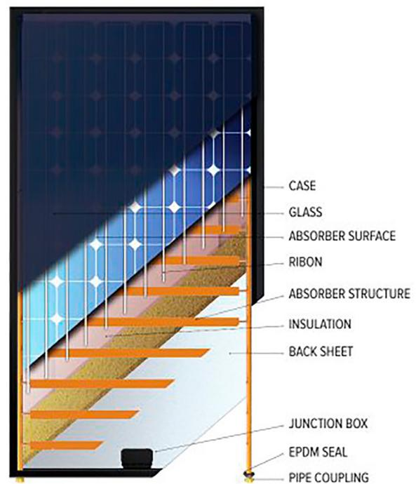
**Figure 4.** PV/T module
