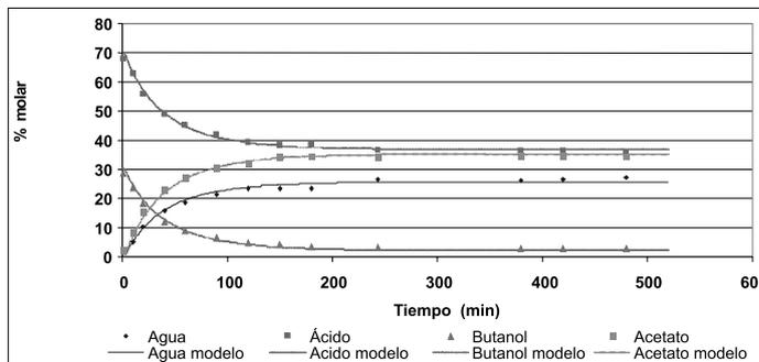
Figura 5. Datos cinéticos experimentales (puntos) en reacción batch y ajuste con modelo Q-HNIDS (línea continua) para el ensayo 3 (0.5% cat., 73°C, Ac Ac:BuOH 2:1)
