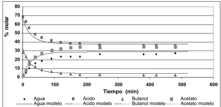
Figura 4. Datos cinéticos experimentales (puntos) en reacción batch y ajuste (línea continua) con modelo seudo homogéneo no ideal (Q-HNIDS) para el ensayo 3 (0.5 % cat., 73°C, Ac Ac:BuOH 2:1)
