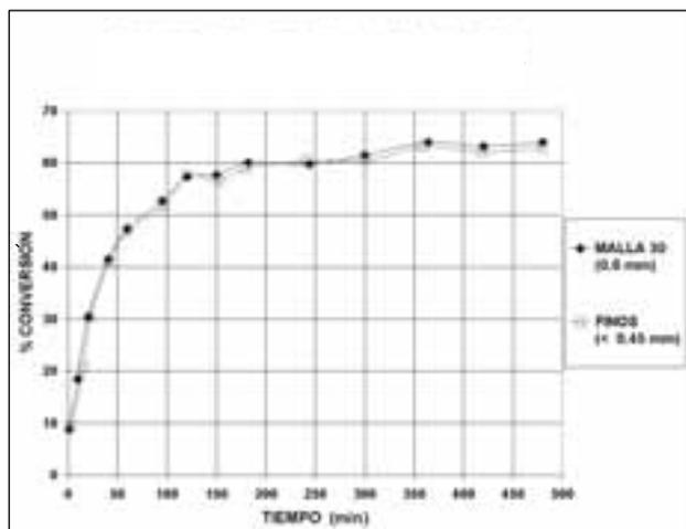
Figura 3. Conversión en reacción con diferentes tamaños de partícula (relación molar 1:1; 80°C; 800 rpm; equivalentes ácidos de resina correspondientes a 0,5% peso de H<sub>2</sub>SO<sub>4</sub>)
