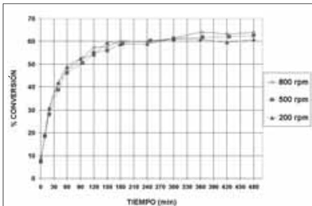
Figura 2. Conversión en reacción a diferentes velocidades de agitación (relación molar 1:1; 80°C; equivalentes ácidos de resina K-2431 correspondientes a 0,5% peso de H<sub>2</sub>SO<sub>4</sub>)
