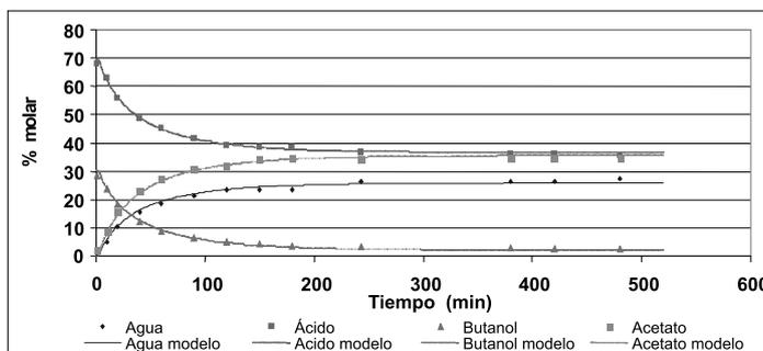
Figura 6. Datos cinéticos experimentales (puntos) en reacción batch y ajuste con modelo LHHW (línea continua), para el ensayo 3 (0.5% cat, 73°C, Ac Ac : BuOH 2:1)
