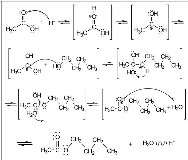
Figura 1. Mecanismo de reacción de esterificación
