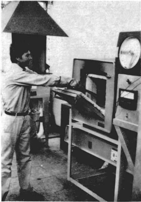
Horno de tratamiento térmico
