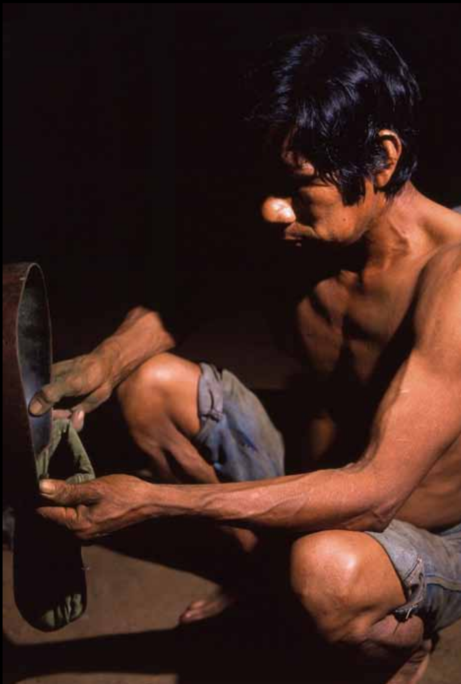
FIGURA 11. “EN ANTIGUA LOGRÁBAMOS UN POLVO MÁS FINO AL CERNIR LA MEZCLA EN UNA TALEGA HECHA CON YANCHAMA” (TELA CONFECCIONADA CON LA CORTEZA DEL BALSO)
