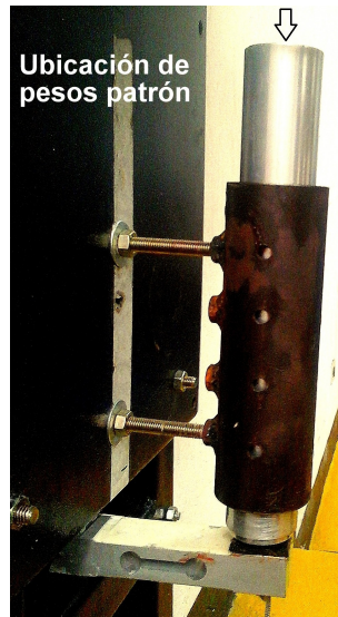
FIGURA 3. Montaje vertical del banco de pruebas.
