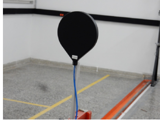
FIGURA 1. Cámara de ionización plano paralela utilizada para la implementación de la calidad RQR3.
