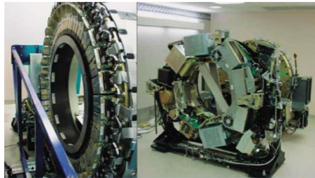
FIGURA 7. Sistema de anillos de detectores centelleadores y tubos fotomultiplicadores de un moderno sistema PET. Dentro de los anillos suele incorporarse algunos módulos electrónicos para el tratamiento y depuración de las señales que serán enviadas luego al módulo (externo) de reconstrucción de la imagen.
