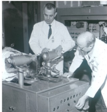
FIGURA 5. Primer prototipo de un escáner para imagenología por emisión de positrones, desarrollado por G. Brownell (izquierda) [14]. Este rudimentario sistema consistía únicamente de dos centelladores de yoduro de sodio enfrentados. El barrido, adquisición de señales y reconstrucción de la imagen debía hacerse de modo mecánico.
