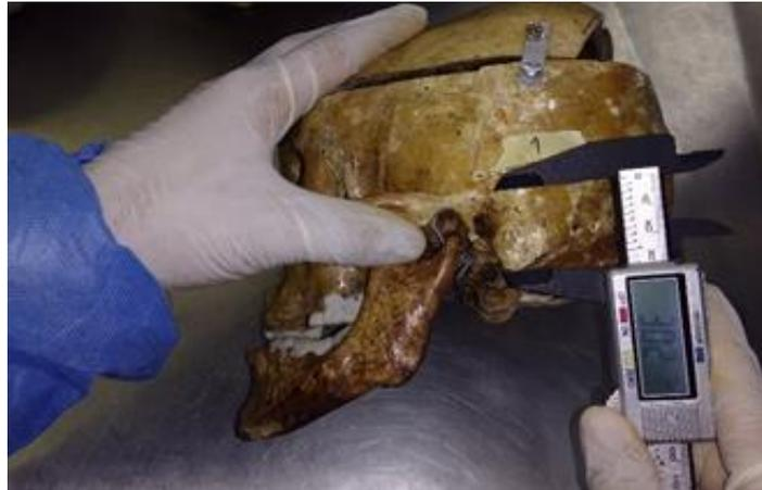
**Figura No.1.** Calibrador digital o pie de rey. Fuente: Foto tomada por los autores en el anfiteatro de la Universidad de Ciencias Aplicadas y Ambientales (U.D.C.A)
