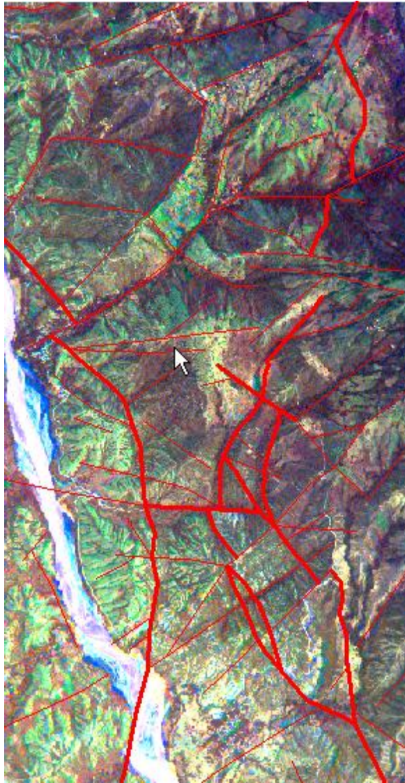
Figura 6. Ejemplo de interpretación estructural en cercanías de Santafé de Antioquia. En líneas rojas gruesas falla mayores y en líneas delgadas lineamientos estructurales menores. Imagen Landsat ETM, Bandas ETM3, ETM2, ETM1 (R,G,B)
