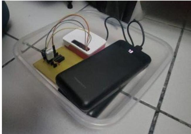
Figura 15. Dispositivo con los sensores integrados (temperatura, humedad y vibración).
