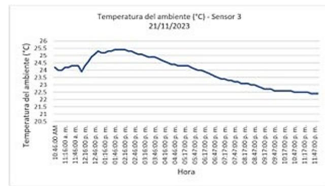
Figura 21. Temperatura del ambiente. (°C), registro en el sensor 3.
