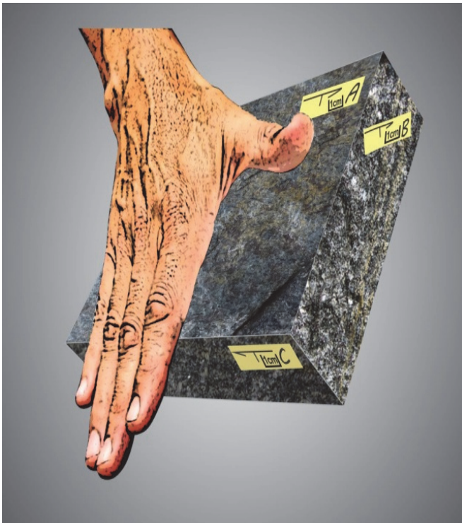
Figura 5. Ilustra la regla de la mano derecha. Observar la dirección del dedo pulgar que corresponde con el rumbo (sentido) del plano. Fuente: Los autores
