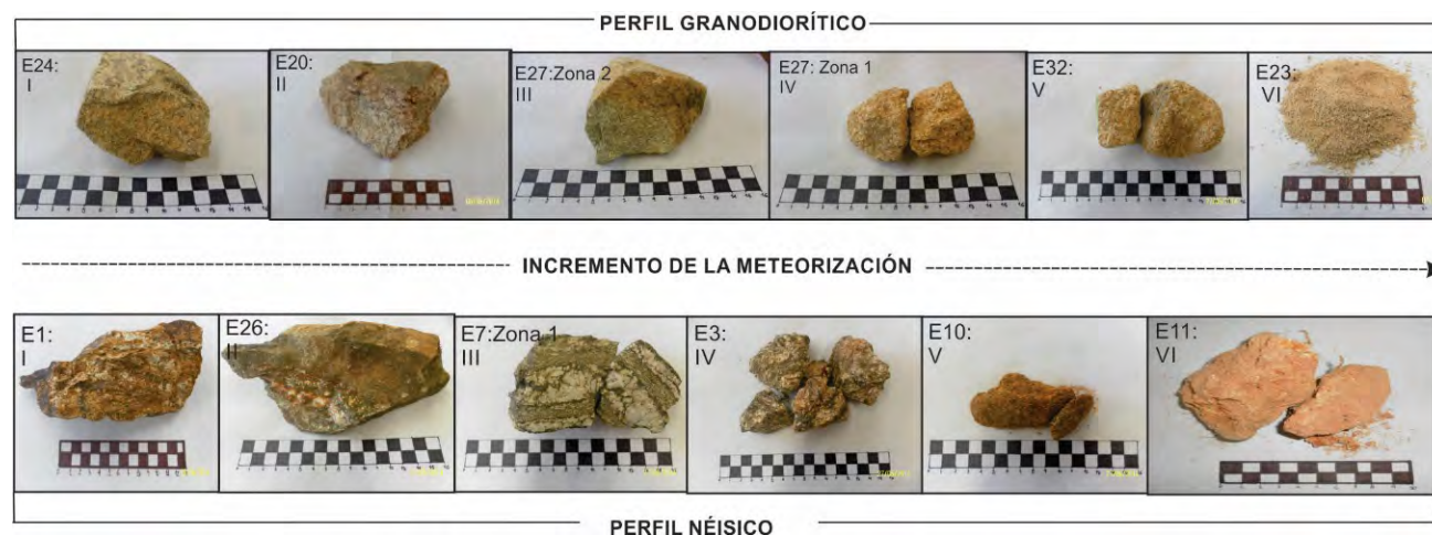
Figura 3. Transición de cada uno de los intervalos de meteorización, mediante propiedades físicas, tanto para el Perfil Granodiorítico como para el perfil Néisico.
