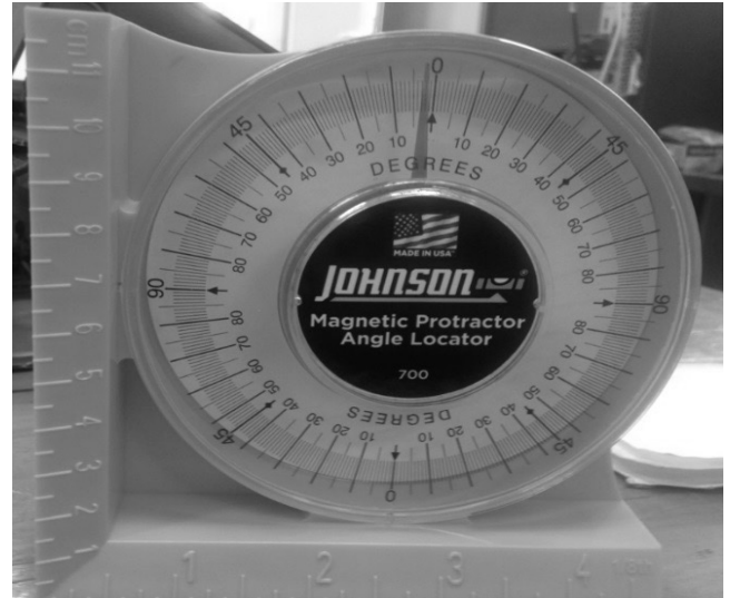
Figura 5. Inclinómetro Johnson "Magnetic Protractor Angle Locator". Fuente: Los Autores.
