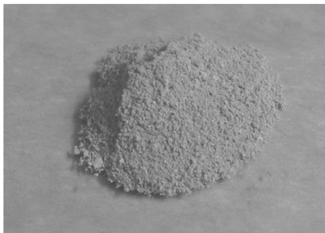
Figura 4. Arcilla macerada con una granulometría inferior a un tamiz # 200.
