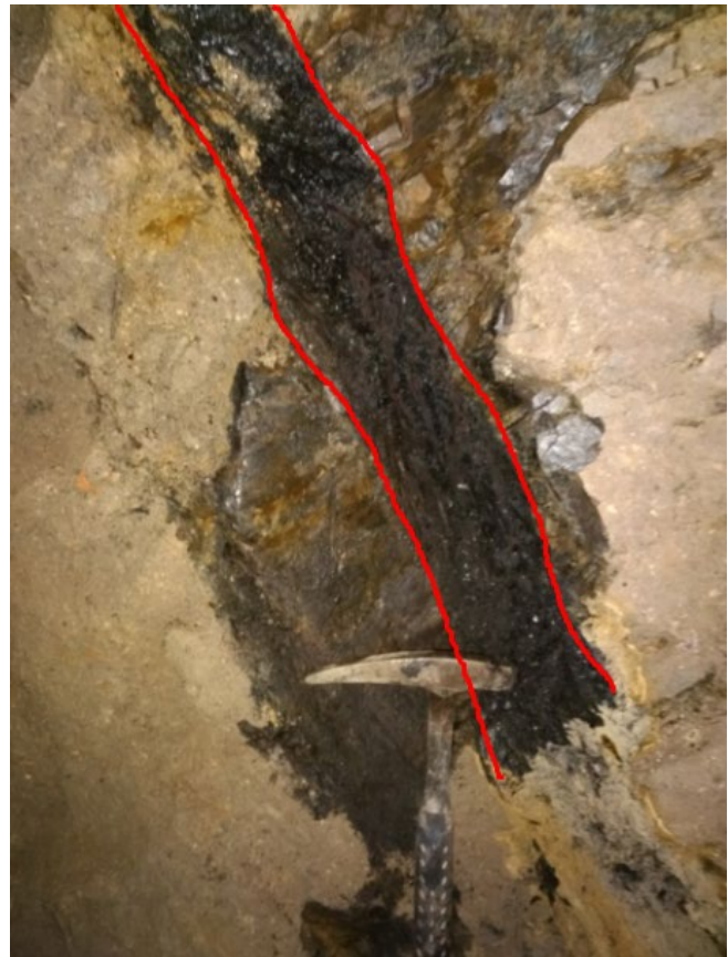
Figura 4. Manto de carbón de la Mina la Lomita de San Bernardo de Bata con un espesor de 0,15m en contacto con arenitas de grano medio.
