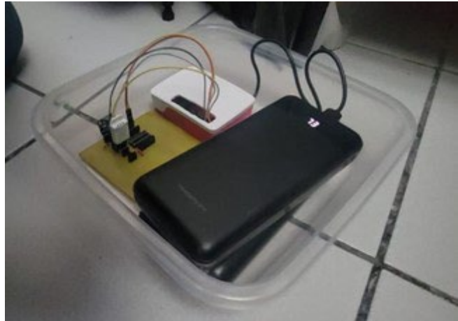
Figura 15. Dispositivo con los sensores integrados (temperatura, humedad y vibración). Fuente: Fotografía tomada por Cárdenas-López, 2023.
