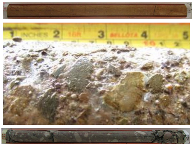
Figura 5. Imágenes que muestran parte del intervalo sedimentario (entre 0 – 835 ft. de profundidad), correspondiente a depósitos arenoso-conglomeráticos y arcillosos del Cuaternario.
