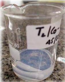
3B: mezcla turbia de baja viscosidad de 9:1 (T1/Co)-A1 40/60 con un 75% de adición de agua.
