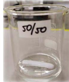
3D: mezcla de gel translucido de 9:1 (T2/Co)-A2 50/50 con un 55% de adición de agua.
