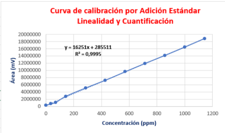
Figura 6. Curva de calibración por adición estándar para la determinación de linealidad y cuantificación del método analítico.
