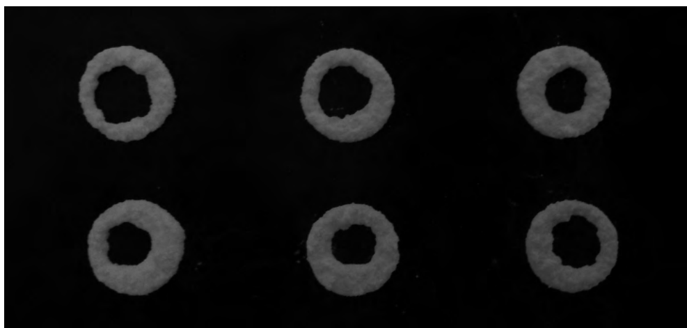
Figura 6. Formación de aros en la prueba de desintegración.
