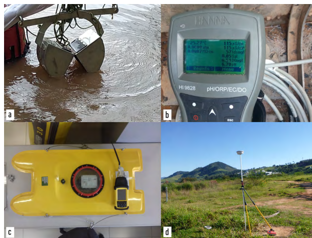
Figura 7. Equipos utilizados en el trabajo de campo: a) muestreador Van Veen; b) sonda multiparámetro Hanna HI9828; c) caudalímetro Qliner V3 y; d) receptor Leica L1 y L2 GNSS.
