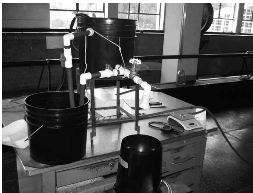
FIGURA 7. Instalación de calibración de pluviógrafos con suministro constante de caudal, a través de válvula de mariposa graduada.
