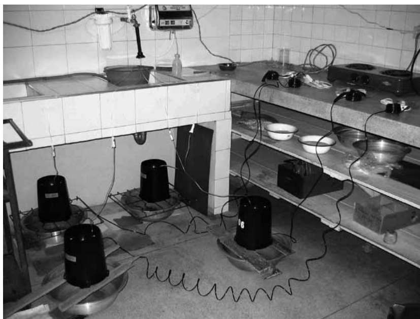
Figura 8. Instalación de calibración de pluviógrafos con suministro constante de caudal, a través de equipo de venoclisis.
