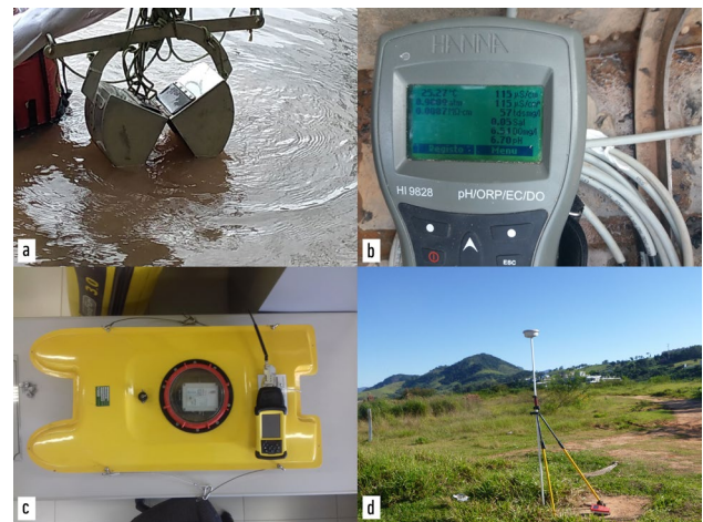
Figura 7. Equipos utilizados en el trabajo de campo: a) muestreador Van Veen; b) sonda multiparámetro Hanna HI9828; c) caudalímetro Qliner V3 y; d) receptor Leica L1 y L2 GNSS.
