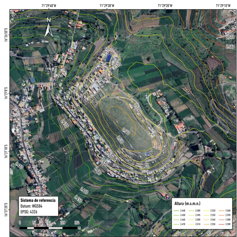
Figura 12. Topografía y curvas de nivel de los terrenos estudiados, cerro Yumina y Buena Vista. Datos: Imágenes satelitales 2023. Modelo Digital de Elevaciones en ArcGIS.
