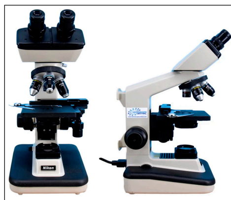
Figura 2. Microscopio óptico Nikon Alphaphot-2 YS2 usado para medir el tamaño de gota.
