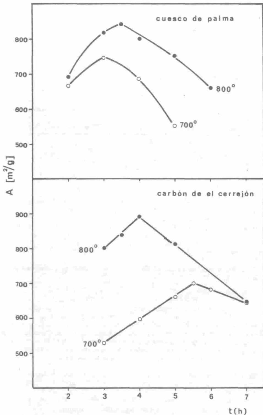
FIGURA 2. Efecto del tiempo de activación con KOH y de la temperatura, sobre el desarrollo de área superficial.
