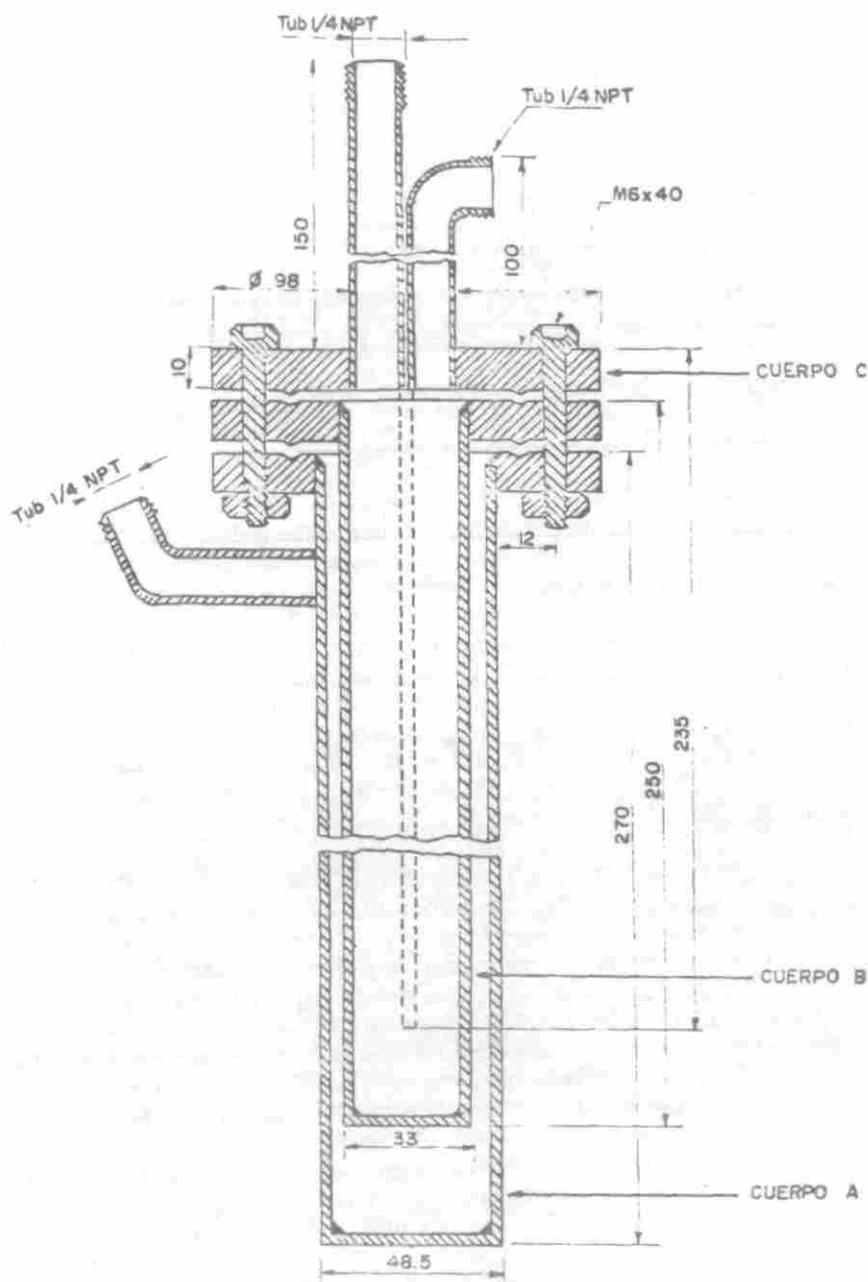
FIGURA 1. Reactor de activación física y química hecho en acero con entrada y salida para gases y sistema de medida de temperatura y presión internas (dimensiones señaladas en mm).
