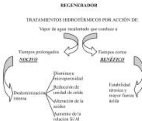
Figura 1. Diagrama representativo del efecto del vapor de agua en la zeolita Y.
