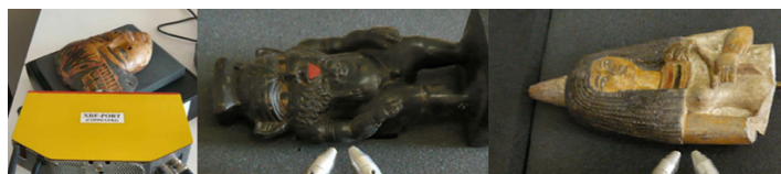
Figura 17. Medición de piezas de arte con un espectrómetro de EDXRF portátil. Tomado de [83].
