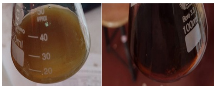
Figura 2. Mezcla de reacción entre los extractos acuosos de queñua, la solución de \text{AgNO}_3 y NaOH.
