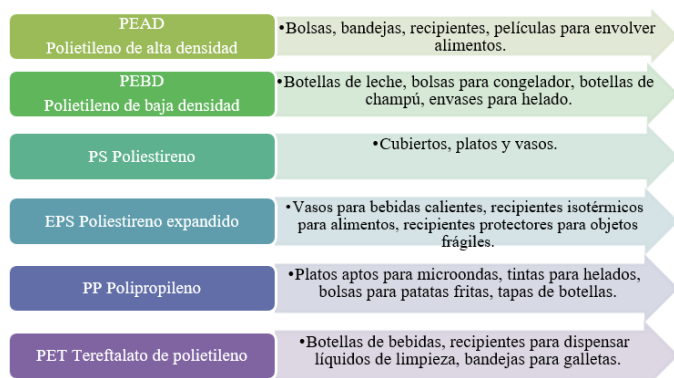
Figura 1. Principales polímeros utilizados para la fabricación de plásticos de un solo uso. Adaptado de [7].
