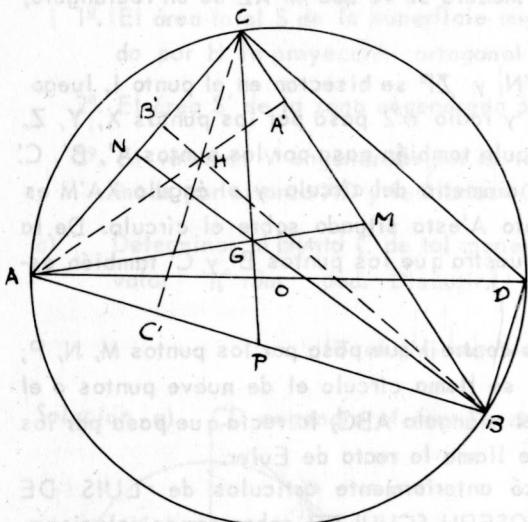
b) Las diagonales  $BC$  y  $HD$  del paralelogramo  $HCDB$  se cortan en sus puntos medios. Puesto que  $M$  es el punto medio de  $BC$ , también lo es de  $HD$  y por consiguiente  $AM$  es una mediana del triángulo  $AHD$ . El punto  $G$  divide el segmento  $AM$  en la razón  $2 : 1$ , siendo  $G$  centro de gravedad del triángulo  $AHD$ .
