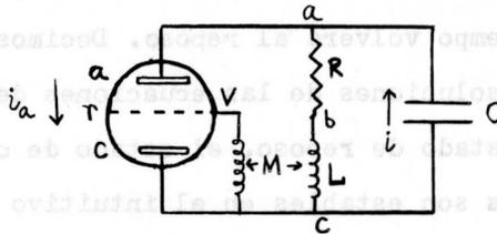
El tríodo a r c consta de ánodo a, rejilla r, cátodo c; Entre r y c existe una diferencia de potencial V (voltaje de rejilla). Entre los polos a y b fluye la corriente  $i_a$  (corriente de ánodo). La "característica del tríodo" es la función
