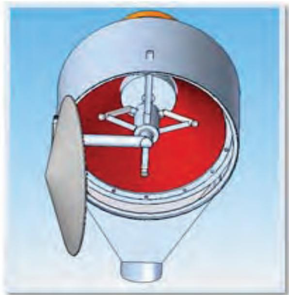
**Figura 1.** Vista isométrica de la separadora centrífuga.
