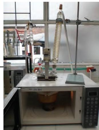
**Figura 1.** Horno microondas doméstico modificado para la extracción de pectina por microondas.
