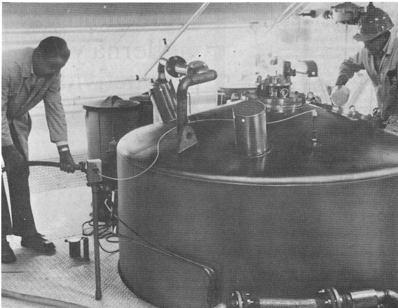
Parte superior de fermentador industrial de 3.000 galones.
