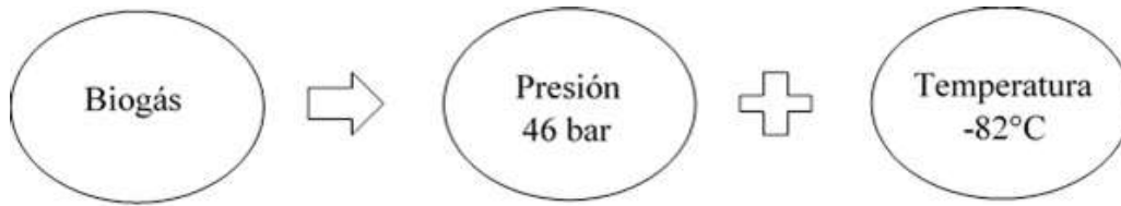
Figura 5: Condiciones para licuar el biogás. Fuente: Elaboración propia.
