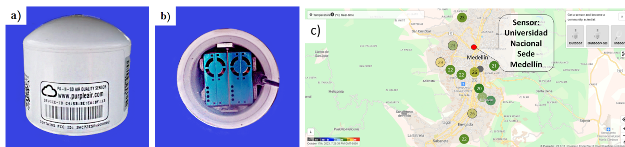
Figura 2: a) Sensor PA; b) Contadores láser PMSX003. Fuente: Botina (2023); c) Ubicación del Sensor PA en la Universidad Nacional de Colombia- Sede Medellín. Fuente: mapa de PurpleAir (2024).
