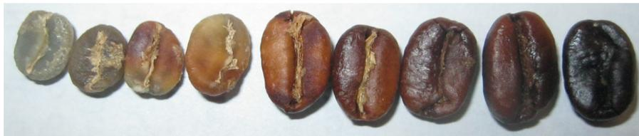
Figura 4: Cambio de color y tamaño de grano con el tiempo de calentamiento, foto tomada a granos de las muestras de los ensayos descritos en la sección 3.1. Fuente: Elaboración propia.
