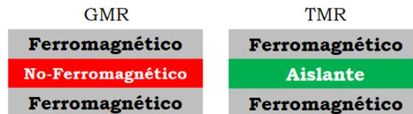
Figura 8: Composición básica de materiales con configuración GMR y TMR. Fuente: Elaboración propia.
